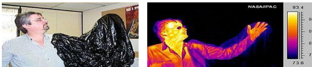
Slika 6. Prozirnost plastične vreće za infracrveno zračenje
