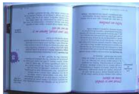
Slika 10. Knjižni blok ulijepljen u jednodijelne kartonske korice s pogrešne strane
