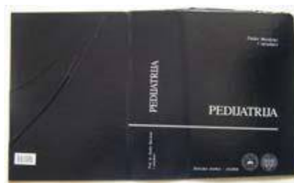
Slika 9. Presvlaka višedijelnih tvrdih korica nije centrirana
