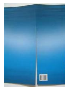
Slika 5. Odrezana klapna na jednodijelnim kartonskim koricama tipična je greška nastala nepažnjom radnika
