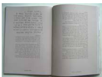
Slika 8. Knjižni blok unutar korica pogrešno okrenut
